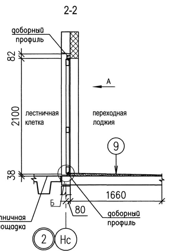
9 - тип пола по экспликации полов
