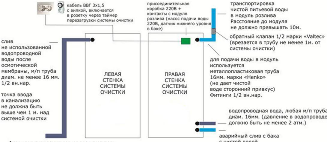
\* если точка входа в канализацию находится на расстоянии более 10 м. от системы очистки, рекомендуется использовать м/п трубу диаметром не менее 20 мм.
